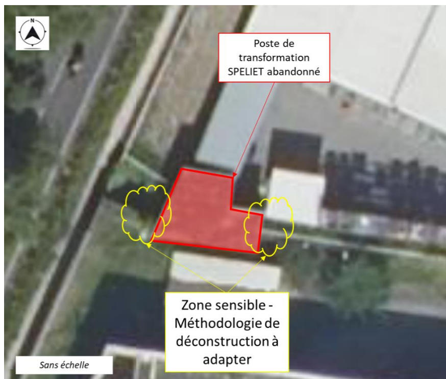
Figure 36 : Tranche optionnelle - Focus sur la zone Nord-Ouest - Poste de transformation
